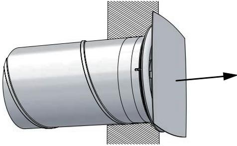
2- Utilizzo di un anemometro con cono per la rilevazione della portata d'aria: Posizionare il cono sopra la valvola e rilevare il flusso d'aria sul display. Ruotare la piastra anteriore per regolare il flusso d'aria. Posizionare nuovamente l'anemometro sopra la valvola e rilevare il flusso d'aria sul display. Ripetere se necessario.
